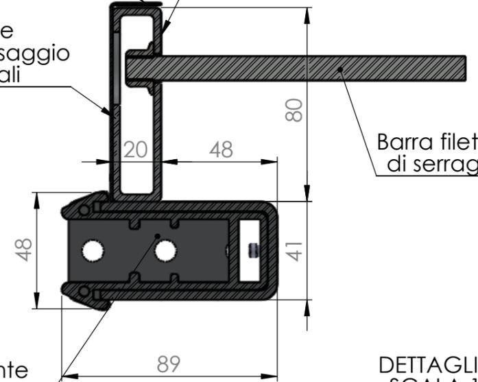
Vano della sez. del montante con antistrappo per il passaggio grata
